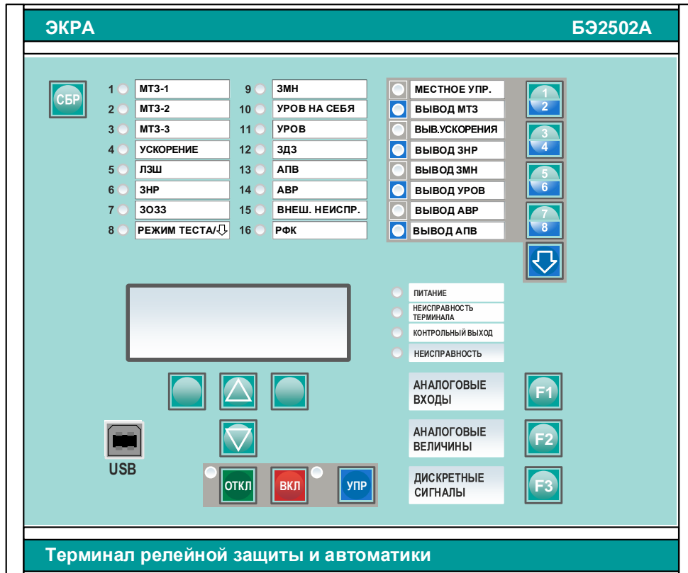
Рисунок 6.3 - Расположение элементов на лицевой панели терминала БЭ2502А0303 (комплект 03)
